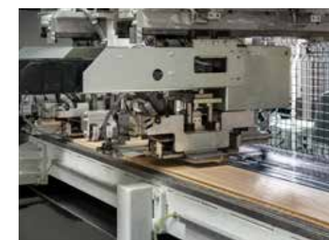
Auffüllen von Ästen und Rissen (vor allem bei rustikalen Sortierungen).
