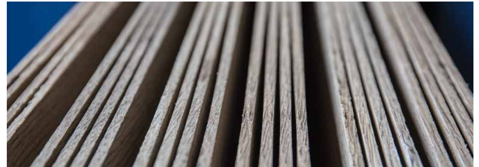
Decklagen im Trockenschnitt für einen Moohreiche-Boden von TRAPA.
