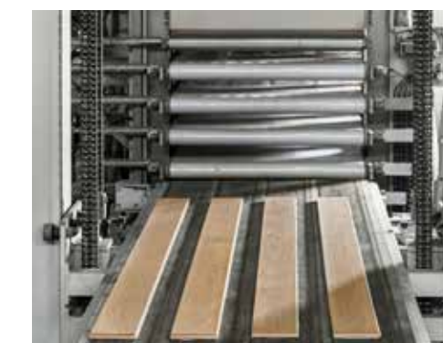
Verpressen der drei spannungsfreien Massivholzschichten.
