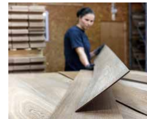
Endsortieren der Decklagen: Das menschliche Auge entscheidet.
